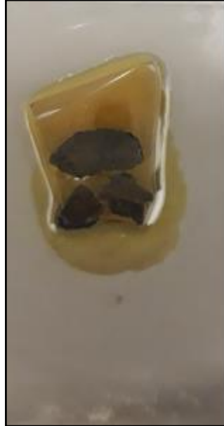
Figura 1: Seção polida com um fragmento do meteorito Santa Catarina Fonte: elaborada pela autora
