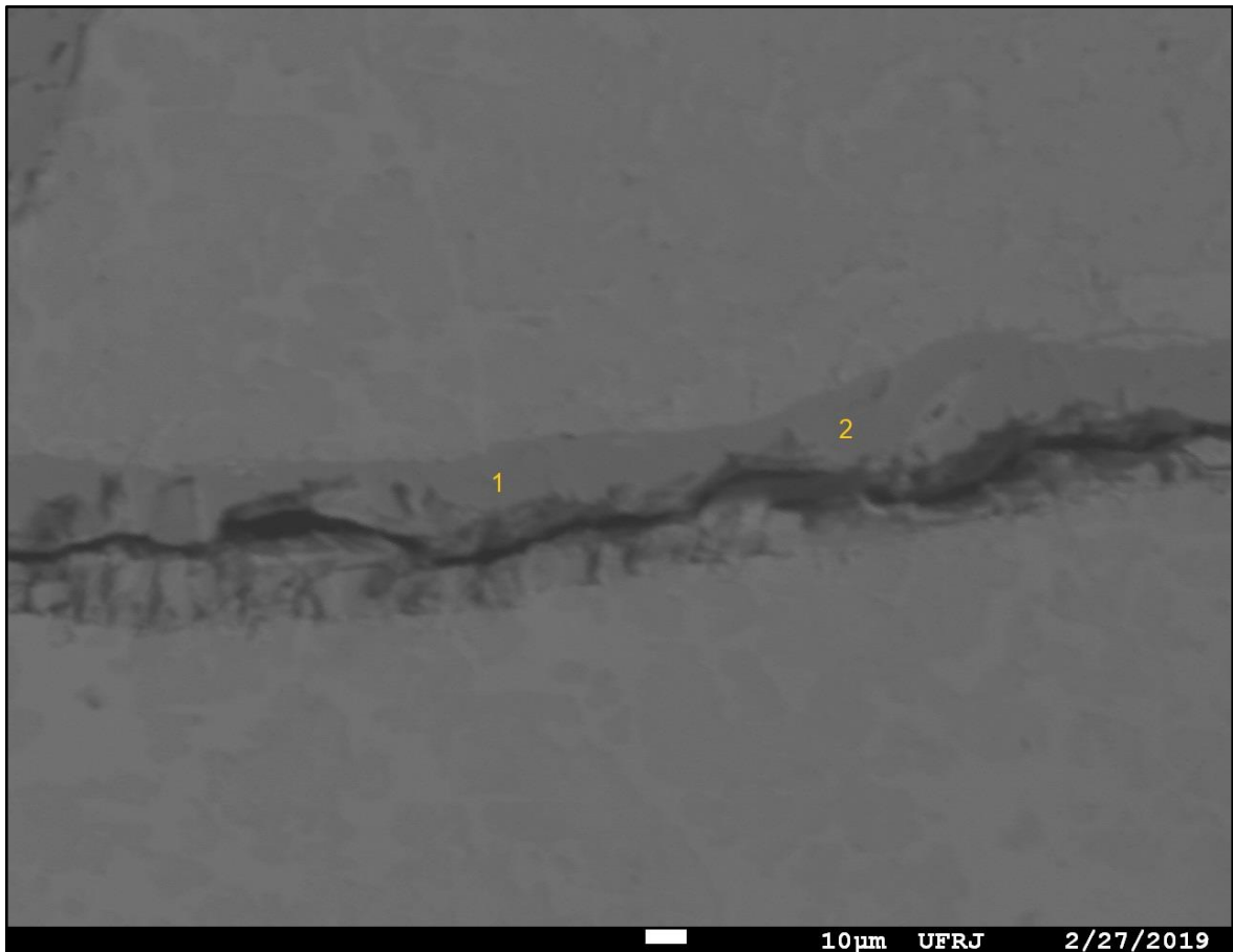
Figura 36: Imagem por elétrons retroespalhados de rachaduras na fase metálica preenchidas com magnetita
