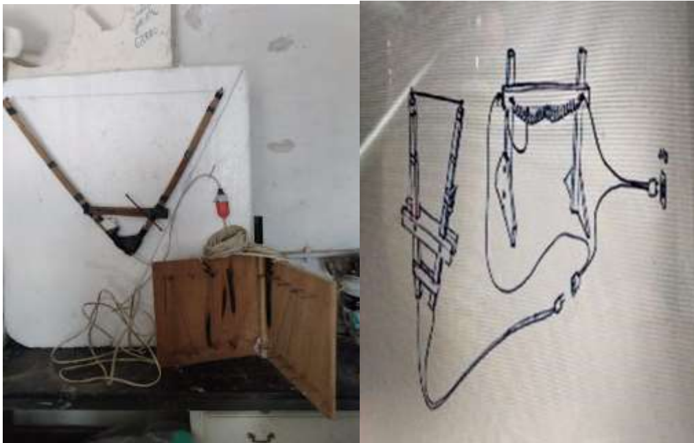
Figura 235 e 236 – Arco que funciona como Segundo Desbaste da Peça
