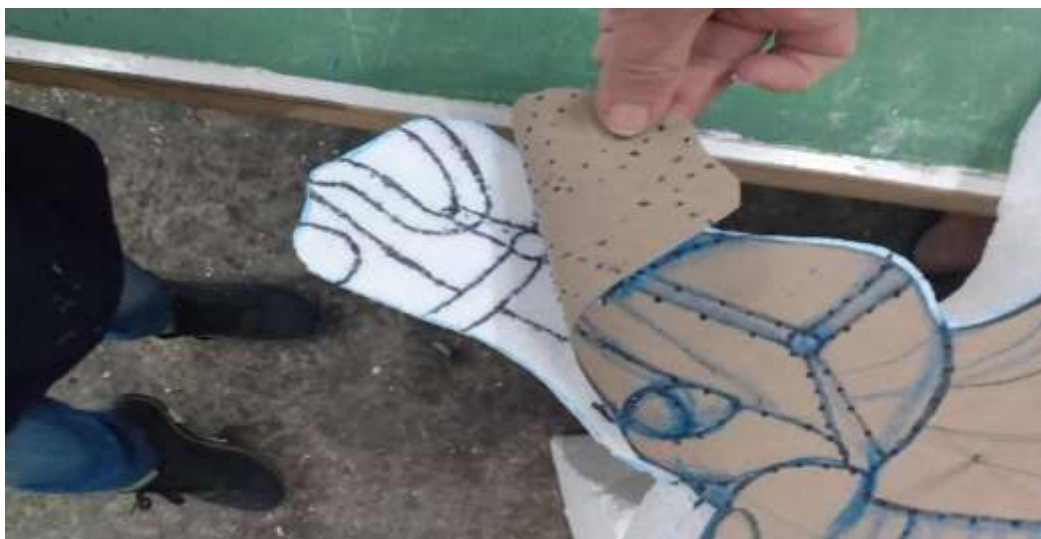
Figura 158 – Transposição do Desenho para Isopor
