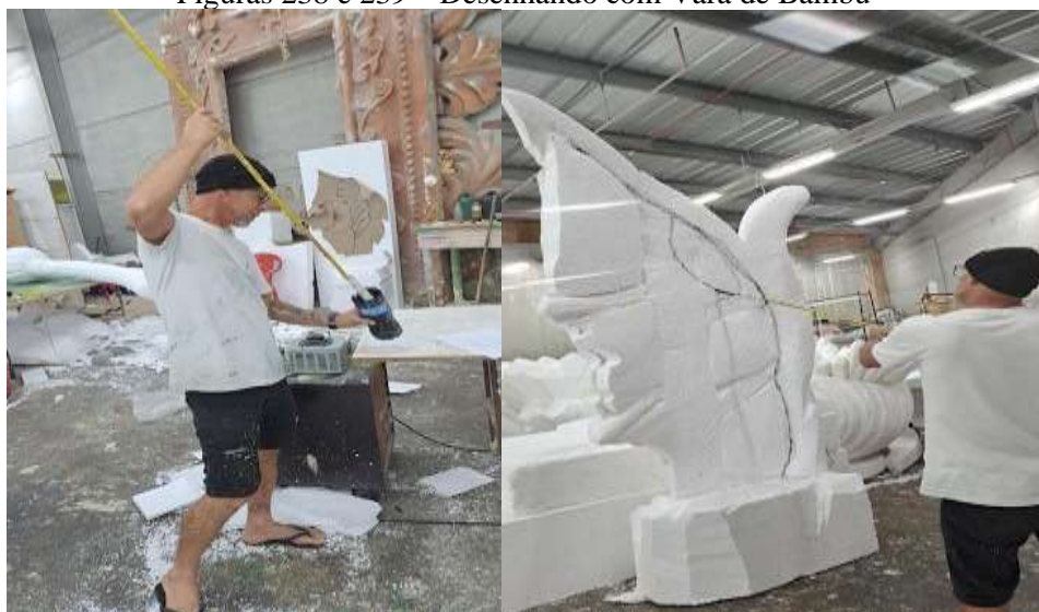
Figuras 238 e 239 – Desenhando com Vara de Bambu
