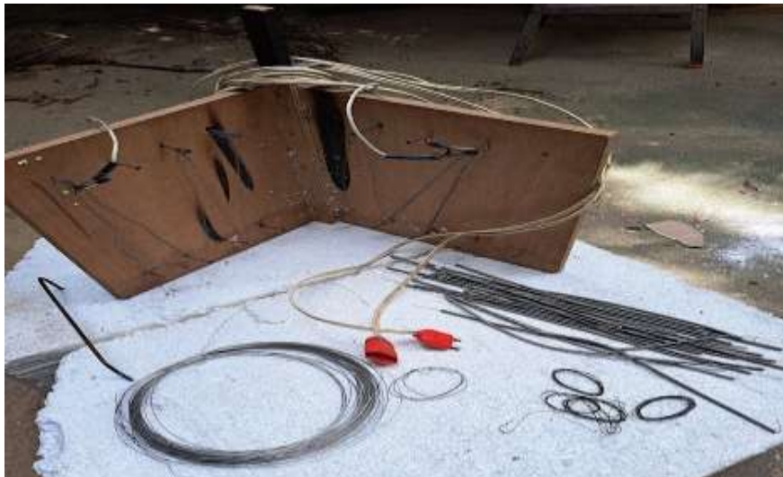
Figura 250 - Aparelho de Madeira com Resistências e Molas de Fio de Níquel
