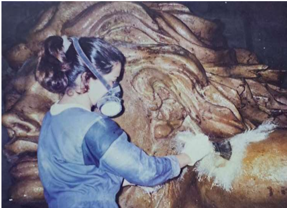
Figura 179 - Laminação com Fibra de Vidro e Resina de Poliéster (Quente) sobre Empastelação
