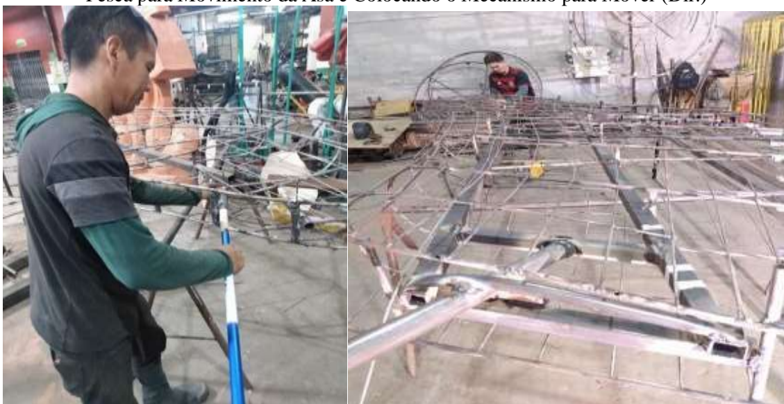
Figuras 85 e 86 – Everson Jatobá, da Equipe Caprichoso Parintins, Experimentando as Varas de Pesca para Movimento da Asa e Colocando o Mecanismo para Mover (Dir.)
