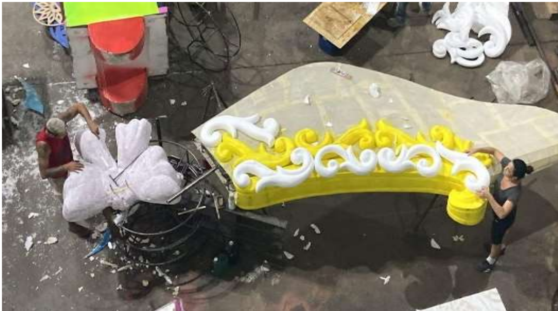
Figura 90 - Colocando Arabescos de Isopor Laminados com Resina à base d'água sobre o Algodãozinho. (Eu e Felipe Vicente)
