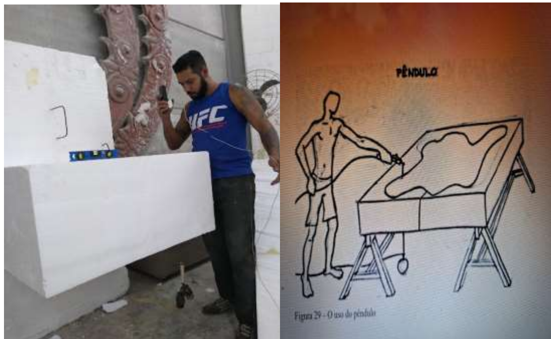
Figuras 233 e 234 - Pêndulo para Cortar Sozinho e Desenho Demonstrativo
