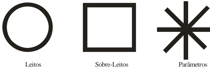
Capítulo 1 - Figura 33: Simbologia de identificação das faces das pedras (desenho do autor).
