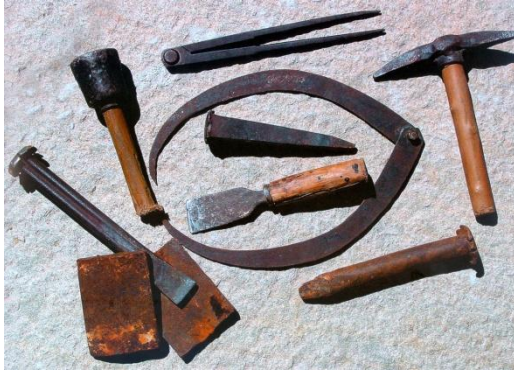
Capítulo 4 – Figura 66 e 67: Instrumentos para a lavra (foto de Antonio Liccardo 43 ) e compasso.
