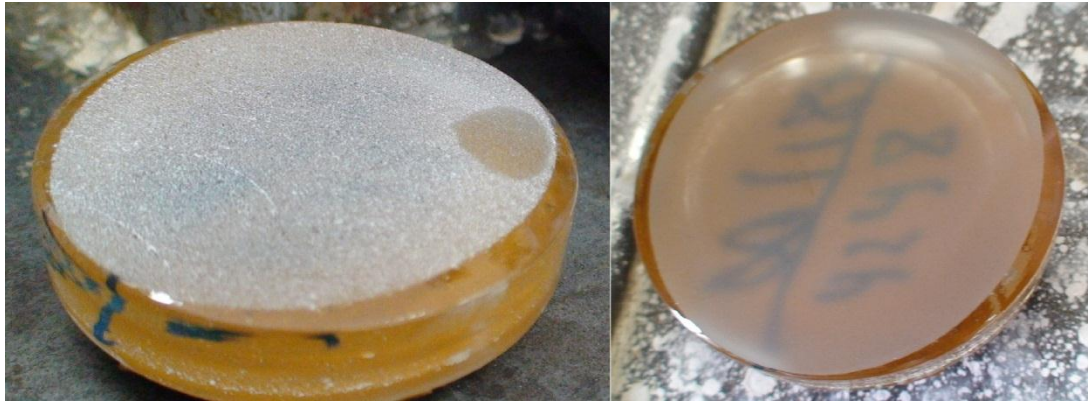
Figura 48 - Superfície extremamente rugosa, à esquerda e pronta para polir, à direita. Fonte: Fotos do autor
