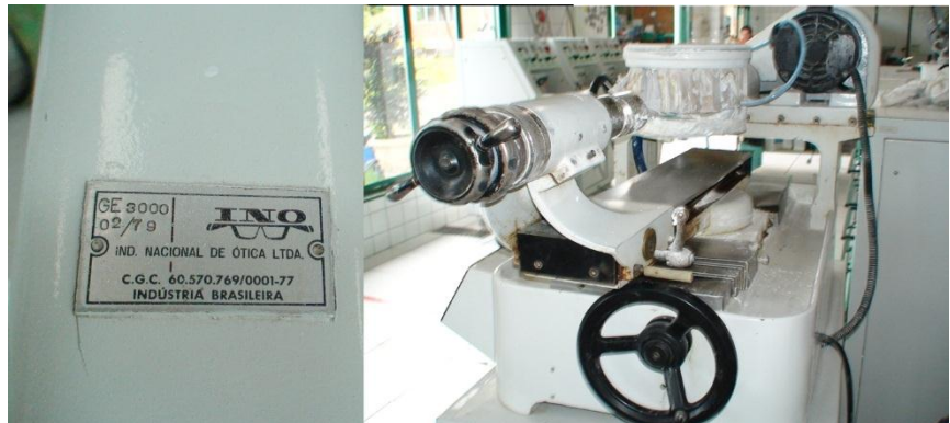
Figura 89 - Gerador de curvas INO, de 1979. Fonte: Foto do Autor. Acervo (TOOLING, 2010).
