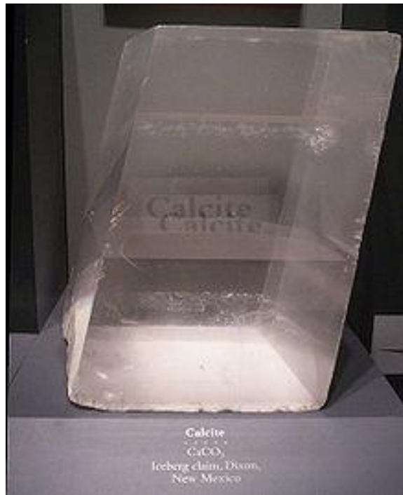
Figura 40 - Dupla refração em cristal de calcita. Fonte: http://en.wikipedia.org/wiki/File:Calcite-HUGE.jpg Acesso em: 16 out. 2012.
