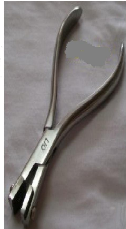
Figura 67 - Alicates para triturar a borda de vidros das lentes. Fontes: (MANZINI, 1660) à esquerda e http://mpereirafornturas.webnode.com.br/optica/ à direita. Acesso: 20 nov. 2012.
