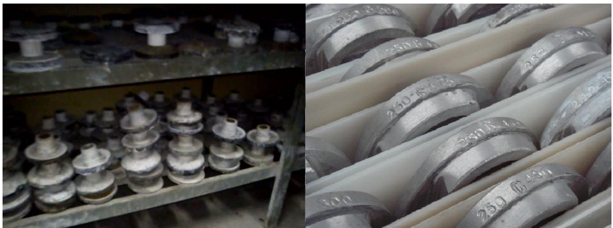
Figura 52 - Moldes de ferro (esq.) e de alumínio (dir.). Fonte: Foto do autor.
