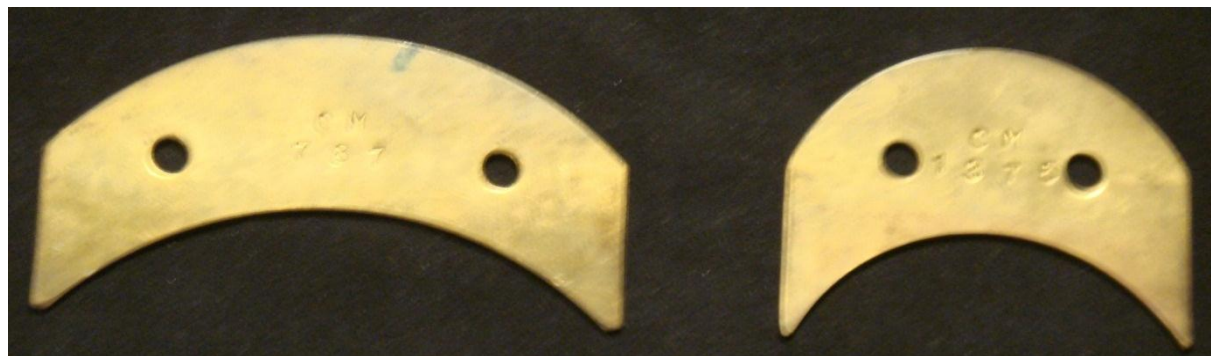
Figura 64 - Calibradores de curvas - séc XXI. Fonte: Foto do autor.
