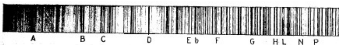
Fig. 9.1 – Posição das linhas de Fraunhofer no espectro solar. A linha D marca o duplete do sódio no amarelo. Nesta imagem, retirada da apresentação de Michelson quando da outorga de seu prêmio Nobel, em 1907, outras linhas já haviam sido “batizadas” ( b , L , N e P ) (NOBEL FOUNDATION, 1998, p. 168).
