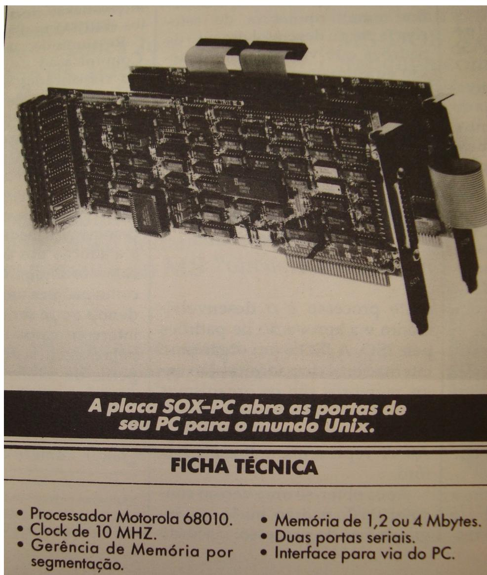
Figura 3.6: Especificação da placa SOX-PC.
