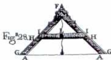
Figura VII-114: Nível . Imagem 28 do Tratado II do Exame de Artilheiros , de José Fernandes Pinto Alpoim (Fonte: ALPOIM, José Fernandes Pinto (1700-1765). Exame de Artilheiros , 1744. Reprodução fac-similar, Biblioteca Reprográfica Xerox, Rio de Janeiro, 1987).
