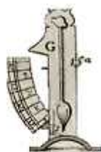
Figura VII-112: Instrumento para apontar peças. O quadrante está na posição em que permanece no seu estojo para ocupar pouco espaço. (Fonte: Fortes, Manoel de Azevedo. O Engenheiro Português . Vol 1, Estampa 7, figura 15, 1728).
