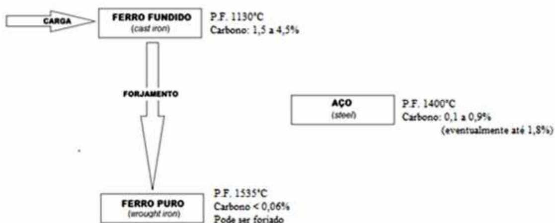
Figura II-16: No alto forno, a carga será transformada em ferro fundido ( cast iron ) que, após ter sido reaquecido e forjado, se transformará em ferro “puro” ( wrought iron ).
