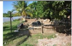
Figura 143 - Secagem dos tijolos
