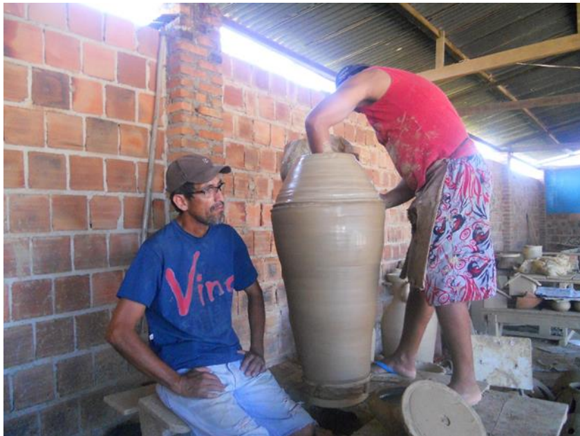
Figura 52 - Modelagem no torno com emenda para construção de vasos grandes
