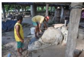
Figura 64 - Preparação do barro sem o uso da maromba
