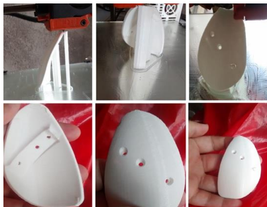
Figura 30. Elementos estruturais internos impressos do coração robótico (paredes). Os encaixes para os dispositivos mecatrônicos estão aparentes nas peças.
