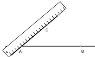
6) A borda da régua é colocada sobre os pontos B e C - (2 x op. $R_1$ );
