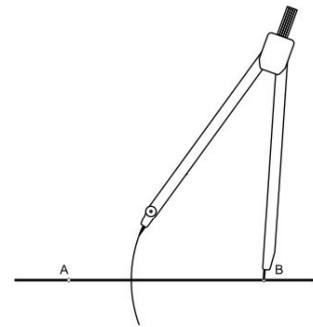
4) A ponta seca do compasso é colocada sobre A e o instrumento é aberto até cobrir a medida AC - (2 x op. $C_1$ );
