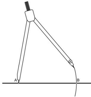
3) A ponta seca do compasso é colocada sobre B e o instrumento é aberto até cobrir a medida BC - (2 x op. $C_1$ );
